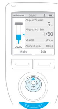
Pulse el botón izquierdo, **Main** (Principal) y seleccione **Manual**. Mueva el joystick hacia arriba para aspirar al menos el 10 % del volumen nominal de la punta del líquido que se va a pipetear. A continuación, pulse el botón Eject (Expulsar) debajo del joystick. NanoRep pregunta: «Empty tip?» (¿Está vacía la punta?) Sujete la punta sobre el recipiente para líquidos y, a continuación, pulse el botón izquierdo **Continue** (Continuar). La punta se vacía. La punta ya está cebada.
